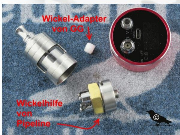
Was gleich auffällt ist die Tatsache, dass man den „Eagle“ nicht wie gewohnt auf einen Wickelsockel schrauben kann. Um dies zu ermöglichen, hat Imeo ein kleines Zusatztool aus Plastik beigelegt, der das Aufschrauben auf einen Wickelsockel oder Ohmmeter möglich macht. Allerdings kann man dabei nicht sehen mit wieviel Ohm man gewickelt hat und auch das „Vorglühen“ des Drahtes ist
