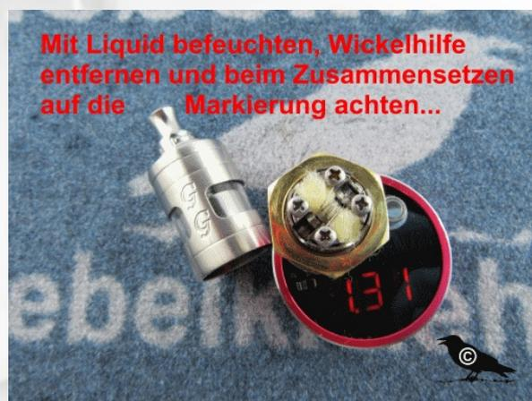
Den beiliegenden Springomizer habe ich auch erst probiert, allerdings ist es sehr schwierig die Feder so einzusetzen, dass man auf ca. 1,3 Ohm kommt. Und das ist nun mal der Wert mit dem ich gerne dampfe. Von daher habe ich die „Handmade-Wicklung“ gemacht und die Drahtenden diagonal an den Schrauben befestigt. Wichtig ist auf jeden Fall das Wickeldeck richtig einzusetzen. Also immer eine der Watte-Seiten in Richtung der
