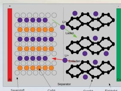
Die beiden „Hälften“ der Akkuzelle sind durch einen Separator getrennt, der jedoch für Lilo durchgängig ist. Damit kann man beim Laden die Lilo in die Anode quetschen.
