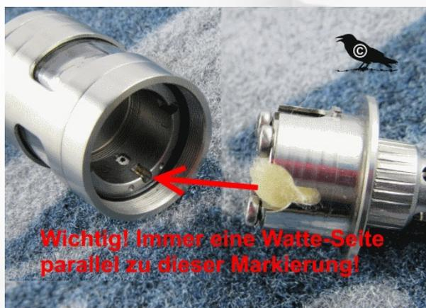
Zum einen darf man sie nicht zu gering aufdrehen und zum anderen nicht zu weit aufdrehen. Ich schaue immer, dass die obere Kante der "Glocke" knapp an der oberen Tankhülse steht oder dass der Buchstabe "E" von der Liquidkontrolle gut zu sehen ist. Das Aufdrehen von Liquidkontrolle und der oberen Kappe geht mit der Zeit leichter, notfalls hilft ein "Einmal-Handschuh".
