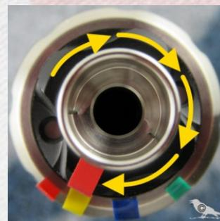
**Gelbe Markierung:** Im Uhrzeigersinn bis zum Anschlag drehen
