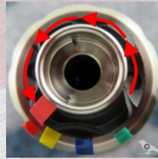
**Rote Markierung:** Weiter gegen den Uhrzeigersinn von der grünen bis zur roten Markierung drehen und die Kaminglocke geht ganz nach oben und ist somit komplett geöffnet. Ein langer Weg, wobei die Gefahr besteht, dass der Tank ausläuft, wenn man gleich bis zum Ende aufdreht. Also lieber Stück für Stück aufdrehen und beobachten, bis man das erste Luftbläschen sieht. Dann kommt schon genug Liquid an die Wicklung und es sammelt sich kein Liquidtropfen in den AC-Kammern.
