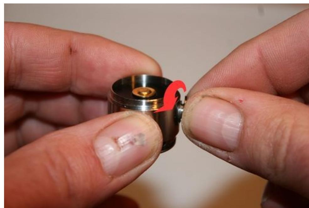
Nun ist die bereits erwähnte Madenschraube zugänglich, welche den Taster in der Topcap hält. Diese lässt sich ganz einfach mit der Fingerspitze herausdrehen.
