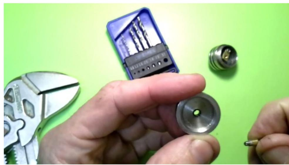
Nun schraubt man die Base und das Deck erst einmal wieder (nicht zu fest) zusammen und markiert sich die zweite Bohrung in der Messingbrücke, indem man mit einem Bohrer durch den nun noch leeren 510er in die Brücke bohrt.
