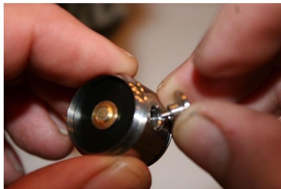
Jetzt zur Bottomcap! Durch drehen der Rändelung gegen den Uhrzeigersinn wird der vergoldete Minuspol komplett gelöst und kann entnommen werden. Der Minuspol kann entweder auch wieder (frei nach Navy) mit den warmen Fingern oder dem Putztuch gereinigt werden.
