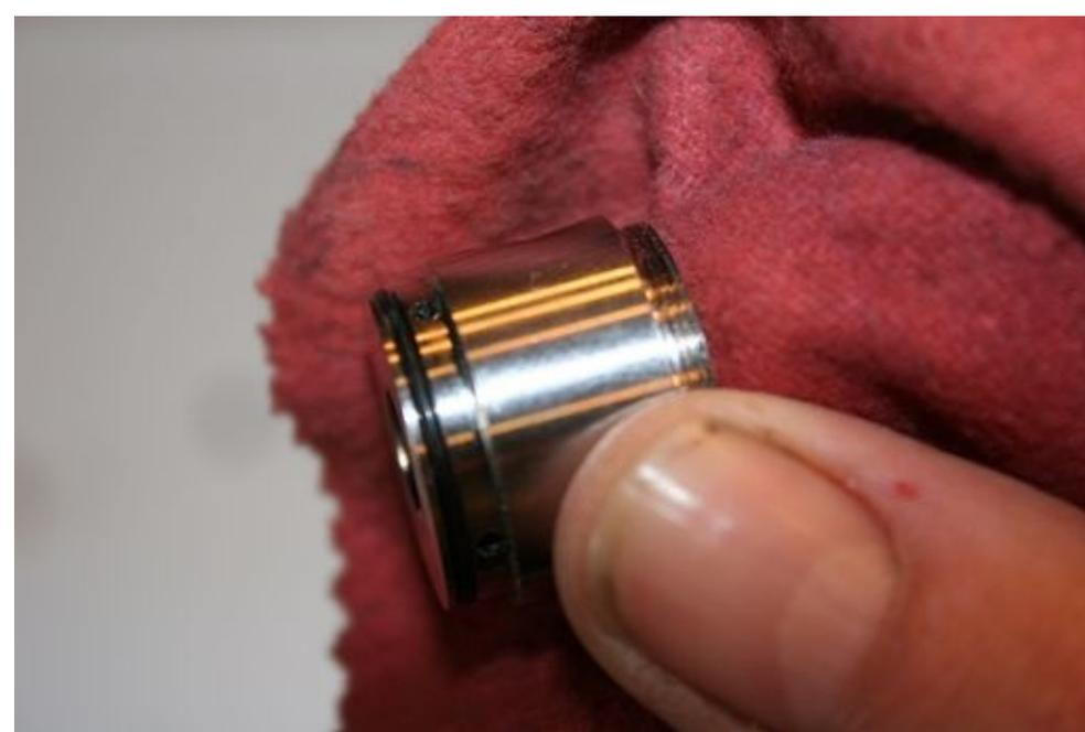
Es folgt der Zusammenbau. Der Isolatorblock wird wieder in die Topcap geschoben. Dabei sollte man darauf achten, dass die Bohrung für den Taster mit der Bohrung in der Topcap übereinstimmt.
