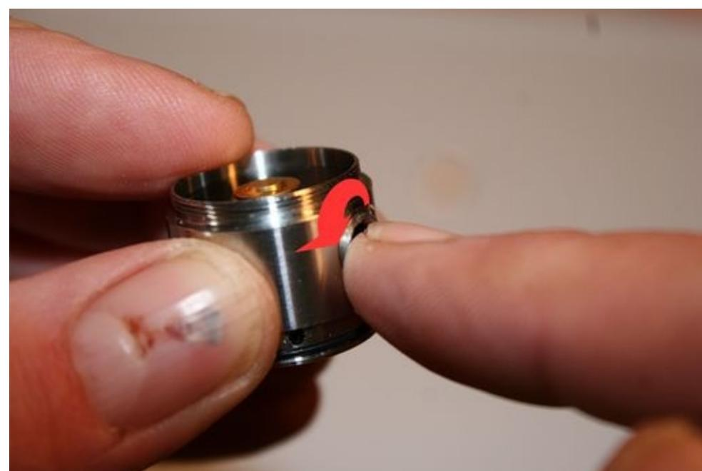
Sobald man diese Schraube entnimmt, sollte man aufpassen, dass einem nicht der eigentliche Taster mit der Kontaktplatte und der Feder um die Ohren fliegt. Diese beiden Teile kann man nun aus der Topcap ziehen.
