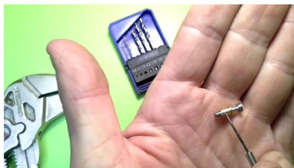
Die Brücke wird wieder montiert. Die ca. 14 mm lange 2.5 mm Schraube für den 510er Pluspol wird durch die durchbohrte Messing-Hülse gesteckt und die Messinghülse von unten in den Isolator gedrückt.
