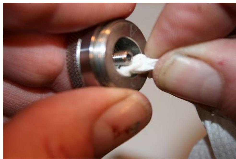
Der Minuspol wird durch drehen der Atermon-Schraube im Uhrzeigersinn wieder angebracht.
