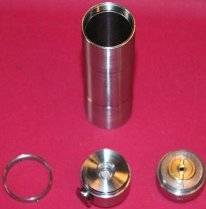
Zur Demontage des in der Topcap befindlichen Tasters schraubt man zuerst den eigentlichen Tasterknopf ab.
