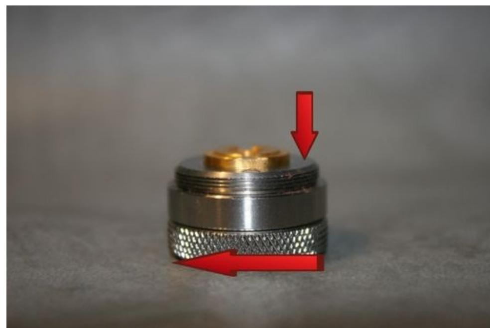
In der Tastereinheit/Topcap ist ein sehr präzise ausgeführtes Gewinde für den 510er Anschluss vorhanden. Für Verdampfer, welche die Zuluft über den 510er beziehen, sind seitlich Bohrungen ausgeführt, die über einen O-Ring gelagerten AFC-Ring eine Verstellung der Zuluftmenge erlauben. Der obere Teil der Topcap ist außerdem als Collectors-Tank ausgeführt, der ca. 0.5 ml ausgelaufenes Liquid auffangen kann, ohne dass dieses in das Innere des Akkuträgers eindringen kann.
