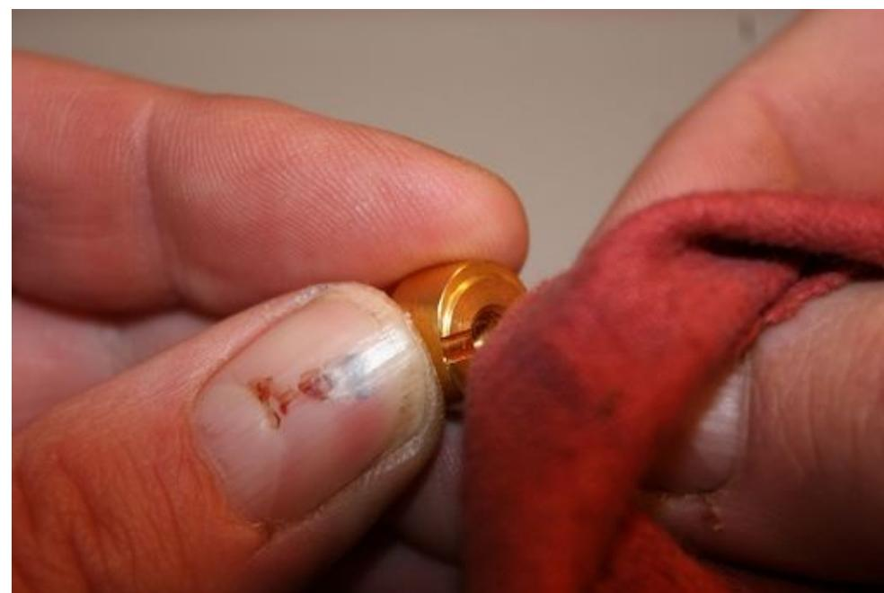
Wichtig ist, dass auf keinen Fall eine Flüssigkeit zur Reinigung der Bottomcap mit der Atermon-Schraube verwendet wird, weil diese in einem geschlossenen und gefetteten Kugellager sitzt. Ein angespritztes Stück Küchenkrepp zum Entfernen von Schmutz genügt vollkommen.
