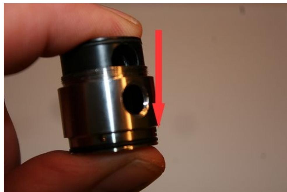
Der Pluspol wird von unten in den Isolator-Block gesteckt.
