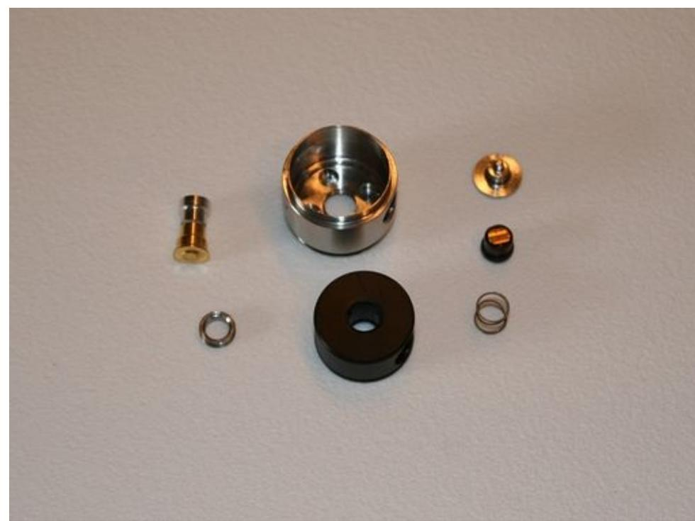
Navy Lifeguard hat in seinem Video zum Atermion erklärt, dass sich die goldbeschichteten Teile für den elektrischen Kontakt leicht mit einem warmen Finger abwischen lassen, ich selbst verwende aber zur Reinigung ein handelsübliches Silberputztuch, mit dem dann die kleine wippend gelagerte Kontaktplatte auf Hochglanz gebracht werden kann.
